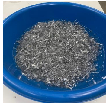
Fig. 8 – Cavacos de alumínio obtidos de resíduos de processos de usinagem.
