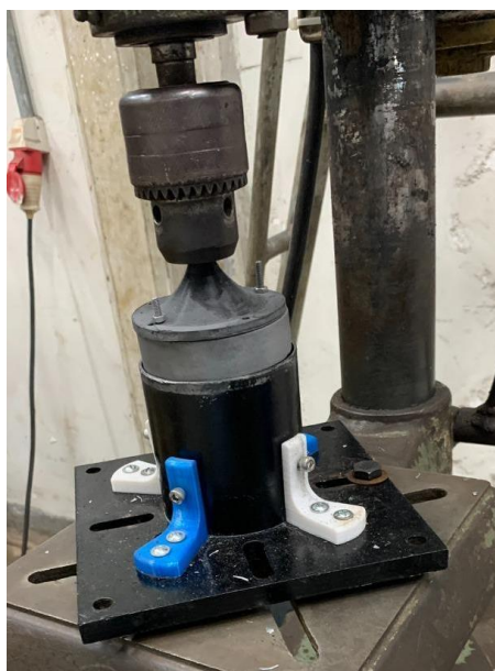
Fig. 10 – Conjunto protótipo – motor pronto para moagem.
