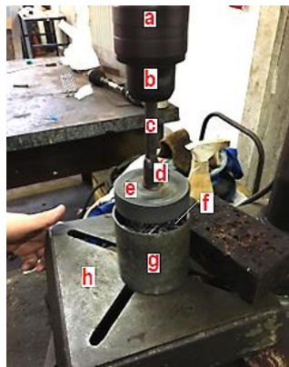
Fig. 1 - Protótipo de dispositivo de moagem adaptado à máquina furadeira de topo: (a) furadeira elétrica; (b) mandril; (c) pino de transmissão; (d) castanha; (e) disco abrasivo; (f) cavacos; (g) câmara para depósito de cavacos; (h) mesa-base.
