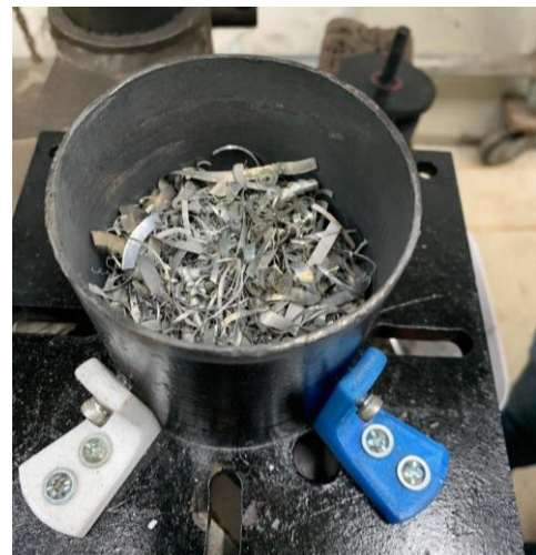
Fig. 9 – Amostra de cavacos de alumínio no interior da câmara de moagem.
