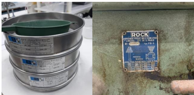
Fig. 7 – (a) Peneiras de separação; (b) especificações da furadeira de bancada.
