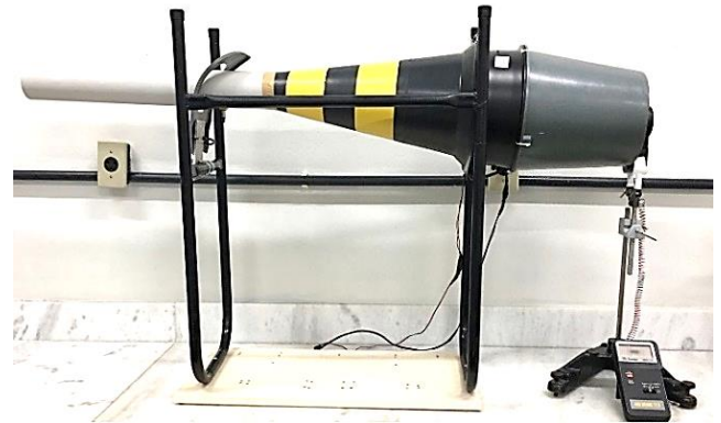
Fig. 3 – Difusor didático com anemômetro na saída ( A_2 ).
