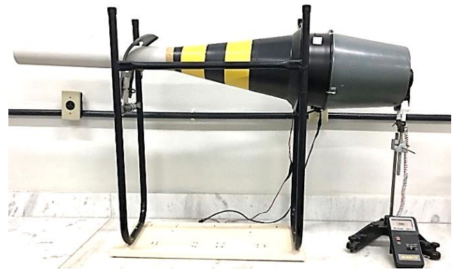
Fig. 3 – Difusor didático com anemômetro na saída ( A_2 ).
