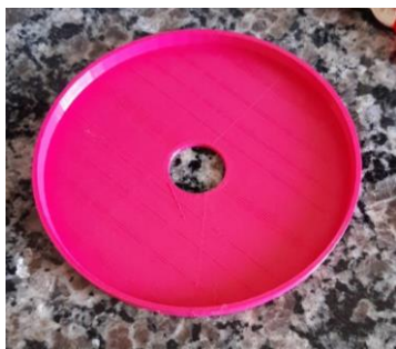
Fig. 3 – Tampa da câmara para cavacos.
