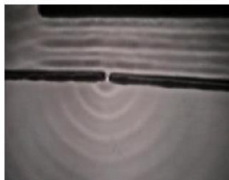
Figura 4 – Aspecto dos pulsos ao passar por um orifício.
