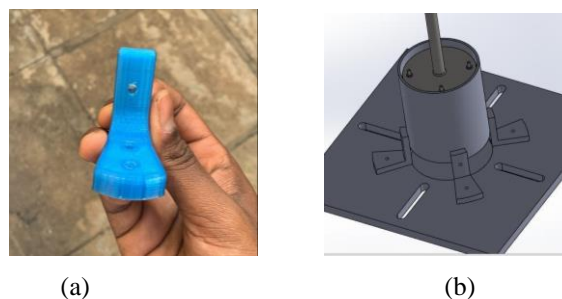
Fig. 5 – (a) castanha de fixação da câmara para cavacos à mesa-base; (b) representação do conjunto mesa-base / castanhas / câmara para cavacos.
