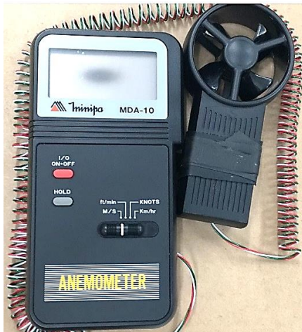
Fig. 4 – Anemômetro de ventoinha.
