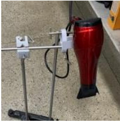
Fig. 6 - Sistema de refrigeração proposto.
