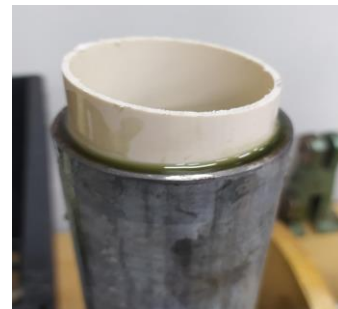
Fig. 9 - Preenchimento do tubo de alta pressão com resina poliéster.
