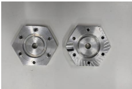
Fig. 12 - Flanges produzidos em alumínio.
