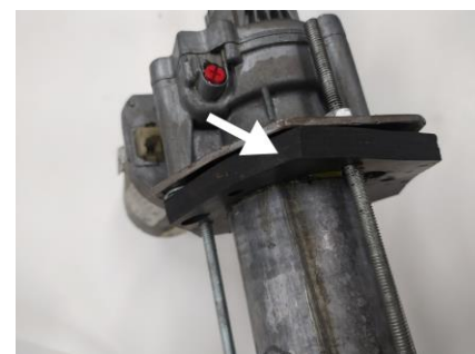
Fig. 20 - Posição da placa de vedação, de borracha.
