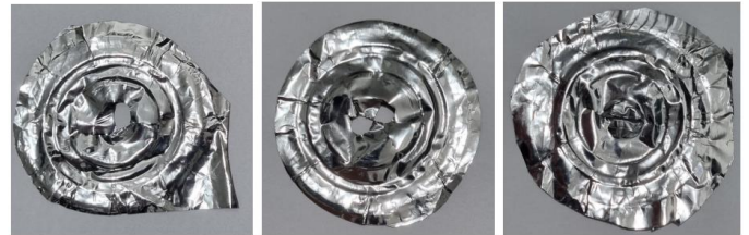
Fig. 24 - Membrana após rompimento.
