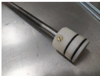
Fig. 7 - Sistema fuso e êmbolo.
