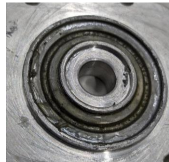
Fig. 19 - Preenchimento dos rasgos com adesivo selante.
