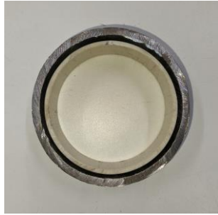
Fig. 10 - Vista da seção transversal do tubo de alta pressão após preenchimento com resina poliéster.
