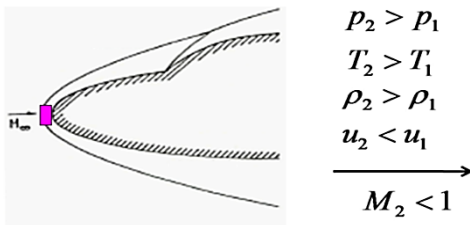
Figura 3. Representação da parte frontal de veículo aeroespacial com geometria rombuda e esquema da relação
