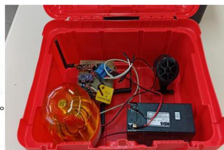
Figura 10. Interface Botoeira e a Maleta contendo sirene e o giroflex e a eletrônica.
