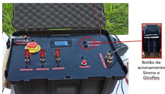
Figura 10. Interface Botoeira e a Maleta contendo sirene e o giroflex e a eletrônica.
