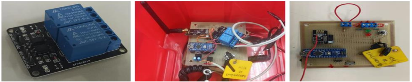
Figura 11. Módulo relé e o circuito dedicado ao acionamento remoto da sirene e giroflex.
