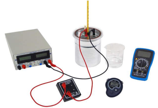
Figura 1 – Montagem experimental para medição do calor específico da água.
