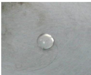
Fig. 7. Gota d’água após 1 min e 30 seg sobre superfície da placa na situação em que T_{placa} > 120\text{ }^{\circ}\text{C} .
