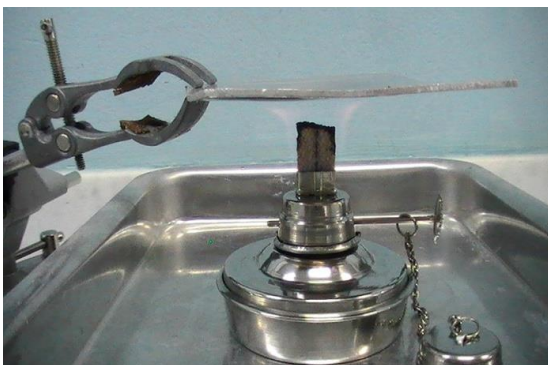
Fig. 5. Aquecimento gradual de gota d'água sobre placa.
