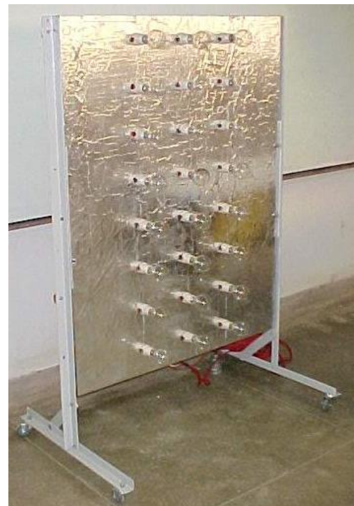
Figura 1 – Fonte térmica / banco de lâmpadas incandescentes
